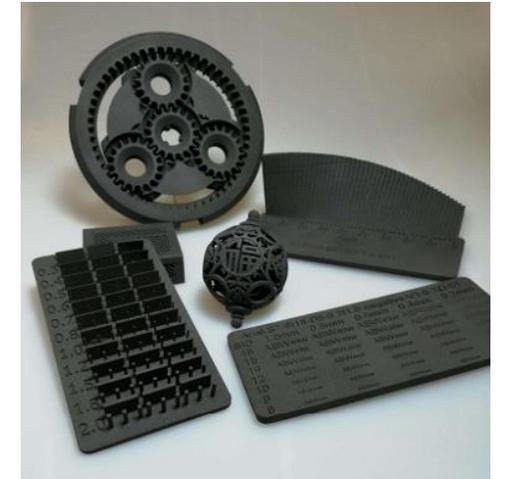
스위스의 Rapid Manufacturing AG사가 HT403P를 활용하여 PA-12 기반의 새로운 재료를 테스트하여 출력한 파트의 모습입니다.
